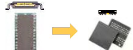
Chips de memoria SDRAM y DDR más comunes- chips TSOP Memoria DDR2 sólo en chips FBGA
